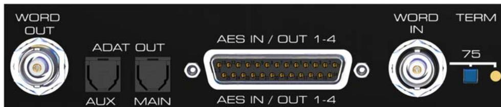
**WORD IN (BNC):** Über den versenkten Druckschalter kann der Eingang intern mit 75 Ohm terminiert werden.
