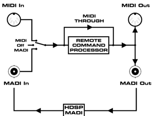
Es lassen sich zusätzlich zu den Remote Befehlen weitere MIDI-Daten übertragen, die dann am DIN Ausgang zur Verfügung stehen. MIDI Signale am DIN Eingang gelangen jedoch nicht zurück zum Computer. In der Schalterstellung MIDI ist die andere Richtung aktiv. MIDI-Daten gelangen über den MADI Out zum Computer, aber vom Computer nicht per MADI zurück zum Micstasy.
