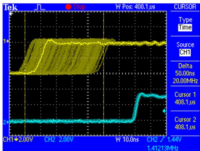
Das gesäuberte und von Jitter befreite Signal kann bedenkenlos in jeglicher Applikation als Referenz-Clock benutzt werden. Das von SteadyClock prozessierte Signal wird natürlich nicht nur intern benutzt, sondern ist auch am Wordclockausgang des Micstasy verfügbar. Es dient außerdem zur Taktung der digitalen Ausgänge MADI und AES/EBU.
