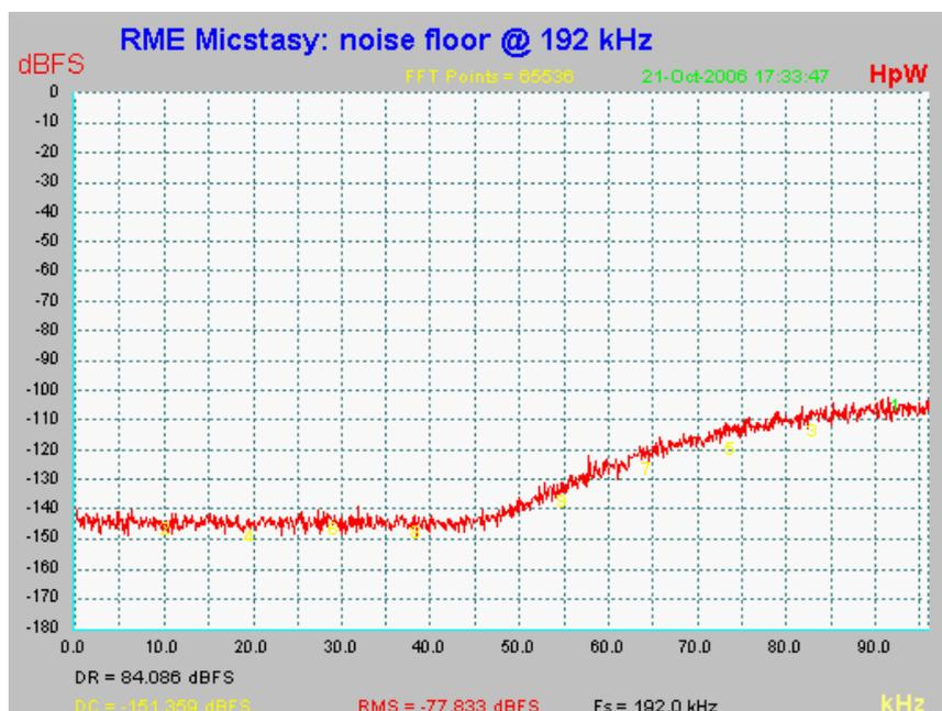
Wie im Bild zu sehen ist bleibt das Grundrauschen bis 45 kHz vollkommen unverändert. Bei Samplefrequenzen bis 96 kHz erfolgt das Noise-Shaping komplett außerhalb des Übertragungsbereiches.
