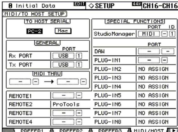
Auf den Remote Seiten 1 bis 4 sind die unten beschriebenen SysEx Befehle für jeden Kanal einzugeben. In der 'Layer' Sektion ist der Remote Layer 1 bis 4 zu selektieren, und der jeweilige Kanal mit dem 'Select' Knopf auszuwählen.
