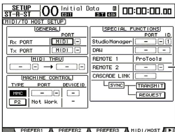
Auf der Seite 'Remote 1' oder 'Remote 2' sind die unten beschriebenen SysEx Befehle für jeden Kanal einzugeben. In der 'Layer' Sektion ist der Layer 'Remote 1' oder 'Remote 2', und der jeweilige Kanal mit dem 'Select' Knopf auszuwählen.
