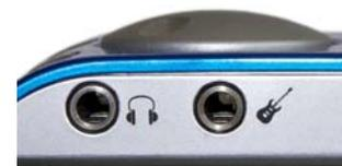
Die analogen Ausgänge **Phones** (Kanal 3/4) sind gleichzeitig am Breakoutkabel und an der rechten Gehäusesseite verfügbar. Die Anschlüsse sind elektrisch nicht getrennt, beim Anschluss von 2 Kopfhörern ist mit verringerter Lautstärke zu rechnen. Das niederohmige unsymmetrische Ausgangssignal ist qualitativ identisch zu dem des Line-Ausgangs, aber im Pegel auf +7 dBu begrenzt.
