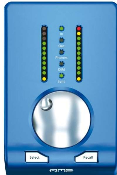
Der Taster **Recall** dient zum Speichern und Abrufen einer definierten Abhörlautstärke für den in TotalMix FX definierten Main Out (Default: Analog 1/2). Durch Druck des Tasters über 2 Sekunden wird die aktuelle Einstellung gespeichert. Wurde die Lautstärke verstellt, kann sie nun über den Taster Recall auf den zuvor gespeicherten Wert zurückgesetzt werden.
