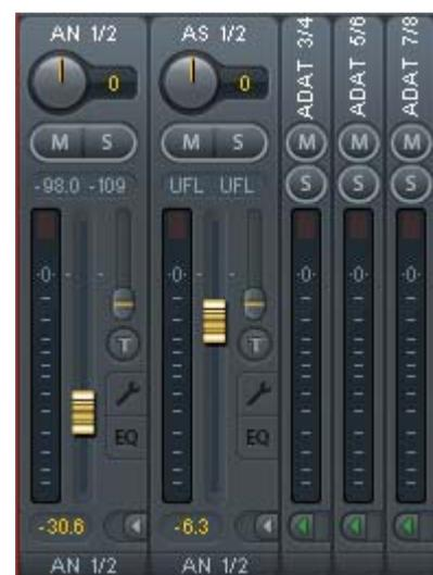
Mit dem **Pfeilsymbol** lässt sich ein Kanal horizontal verkleinern, so dass nur noch die Level Meter zu sehen sind. Ein Mausklick bei gedrückter Strg-Taste führt zum Ein- und Ausklappen aller weiter rechts befindlichen Kanäle.
