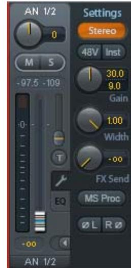
Einen *gesteuerten* Echtzeit-Monitoring-Betrieb erlaubt Steinbergs ASIO Protokoll mit RMEs ASIO-Treibern und jedem ASIO 2.0 kompatiblen Programm. Nach Aktivierung der Option 'ASIO Direct Monitoring' erscheint ab Punch-In das Eingangssignal in Echtzeit am Ausgang.
