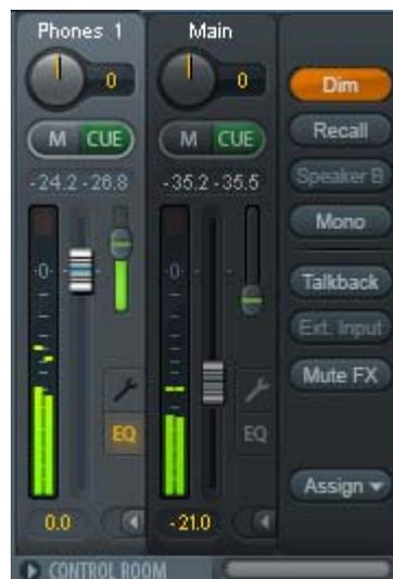
**Speaker B.** Schaltet die Wiedergabe von Main Out auf den Main Out B um. Per Link lassen sich die Fader der Kanäle Main und Speaker B koppeln. Über *Options / Key Commands* lässt sich die Umschaltung auf Speaker B auch mittels der Select-Taste des Gerätes durchführen.
